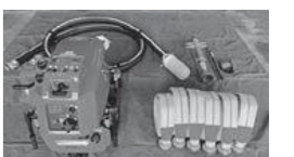
▲更新した可搬式小型消防ポンプ
