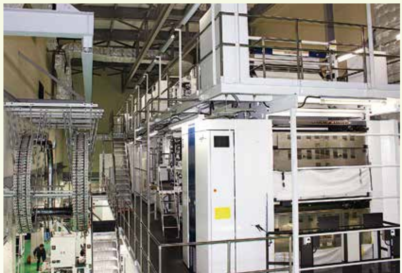
世界最速1時間20万部を印刷する輪転機
