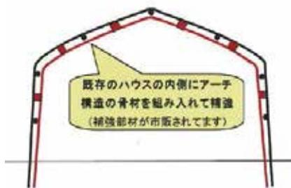
既存のハウスの内側にアーチ構造の骨組みを組み込み補強します。
