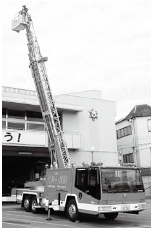
オーバーホールされたはしご付き消防ポンプ自動車
